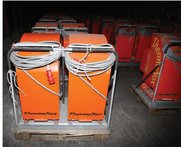
이 기계는 제분공장 내부에 기생하는 눈에 보이지 않는 해충을 냄새와 독성이 있는 약품을 사용하지 않고 제거하기 위한 것이다. 고온 열풍 살충기는 정면이 개방되고 전면벽의 상단에 가열 공기 배출구가 형성된 케이스의 내부 하방에 송풍기가 설치되고 송풍기의 상방에 전열기가 설치되었으며, 전열기의 상방에는 풍향 유도판이 설치되고, 케이스의 전면벽에 전술한 전열기에 공급되는 전류를 실내 온도에 감응하여 차단하는 서모스타트와 메인 스위치를 포함하는 콘트롤박스가 설치된 구성으로 되었다. 고온 열풍 살충기는 서모스타트에 의하여 실내의 온도를 평균 50~60℃ 정도로 유지시켜 주도록 되었으며, 전술한 온도에서 해충의 유충이나 알을 구성하는 단백질이 응고되므로 해충이 사멸되게 된다. 이 기계를 이용하면 혐오스러운 냄새와 독성이 있는 살충제를 사용하지 않고도 창고, 식품공장, 또는 호텔의 실내에 서식하는 해충을 효과적으로 박멸할 수 있는 효과가 있다.
